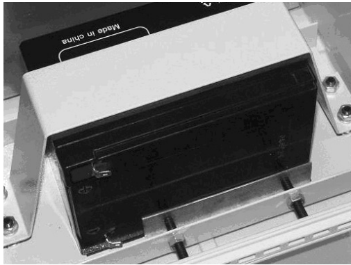
Рисунок 3 Вариант крепления АКБ при вертикальном расположении блока.
